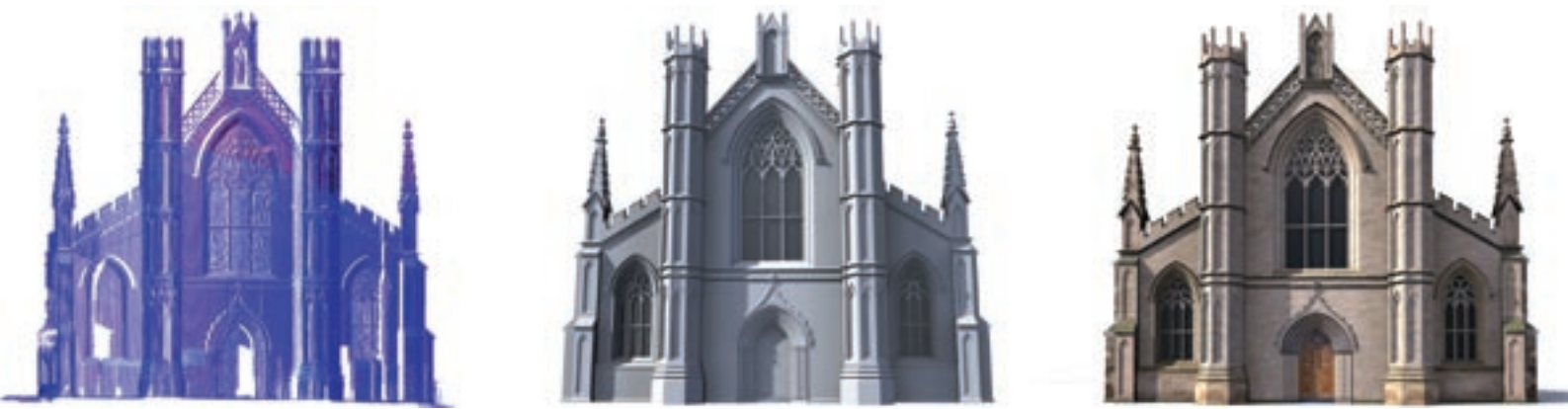
图片（由左至右）：格拉斯哥圣安德鲁斯教堂正面外部的三维激光扫描点云图，精度为厘米级以下；根据最初的点云图构建的三维模型（未经表面处理）；根据数字照片添加真实表面。Douglas Pritchard 供图
